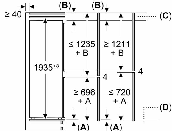
C: Провисване преден панел
